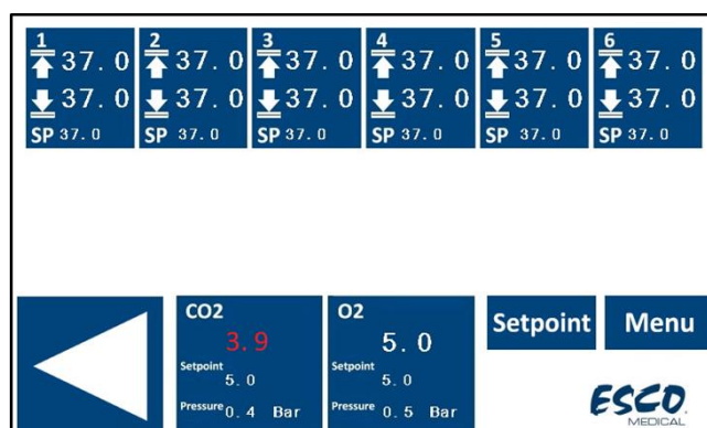
Figura 14.5 Vista de la alarma de concentración de CO 2 baja en la pantalla principal de la incubadora multicámara FIV MIRI® TL6
