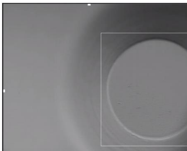
Figura 20.27 Ejemplo de un pocillo colocado incorrectamente en la pantalla de la vista de cámara.
