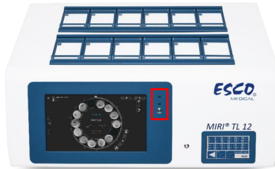
Figura 20.1 Vista frontal de la incubadora multicámara FIV MIRI® TL12 con una marca en el botón de conmutación entre líneas de trabajo e indicación
