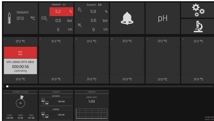
Figura 20.38 Vista de la alarma de concentración de CO 2
