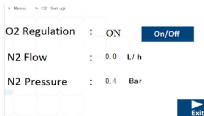
Figura 13.26 Vista del Submenú de O 2 en la incubadora multicámara FIV MIRI® TL6 y MIRI® TL12
