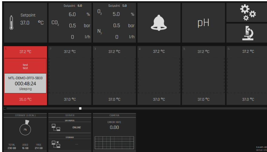
Figura 20.36 Vista de la pantalla de alarma de temperatura
