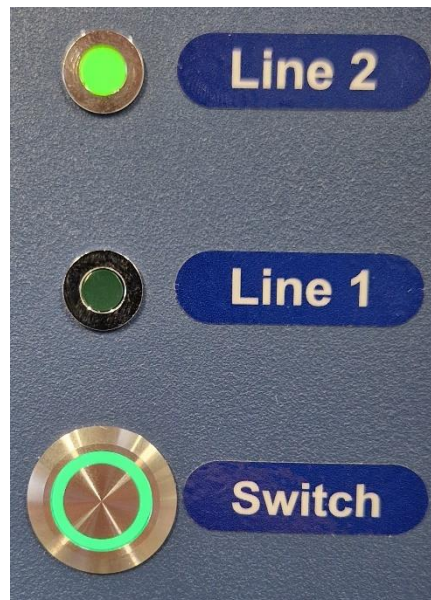
Figure 20.4 El interruptor que cambia la línea de la incubadora multicámara FIV MIRI® TL12 y la Línea 1 activa
