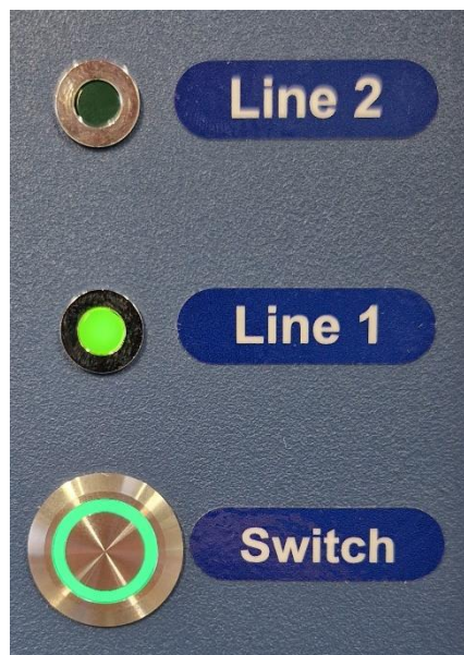
Figure 20.2 El interruptor que cambia la línea de la incubadora multicámara FIV MIRI® TL12 y la Línea 1 activa
