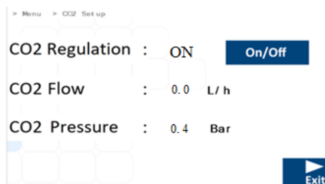
Figura 13.25 Vista del Submenú de CO 2 en la incubadora multicámara FIV MIRI® TL6 y MIRI® TL12
